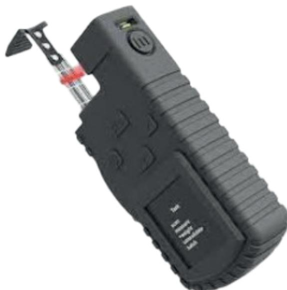
Il metro digitale Bluetooth consente la lettura di barcode (identificativi di un pacco o di un pallet) tramite un lettore laser incorporato e rileva e registra le dimensioni dei colli o dei pallet.
