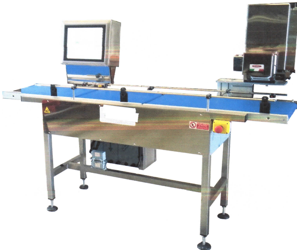
Macchina pesoprezzatrice automatica – Controllo peso automatica Automatic weighing and pricing machine- automatic check weigher
