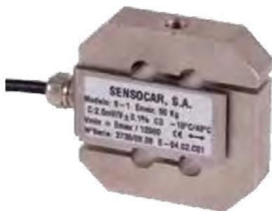
Capacità: 30/50/75/100/150 kg • Fino a 6000 divisioni OIML-R60 • Supporto elastico di acciaio allegato • Protezione anticorrosione con nichel • Protezione contro l'umidità IP-67 • Materiale acciaio inox
