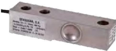
Capacità: 400/500/750/1000/1500/2000 kg • Fino a 4000 divisioni OIML-R60 • Supporto elastico di acciaio allegato • Protezione anticorrosione con nichel • Protezione contro l'umidità IP-67 • Materiale acciaio inox
