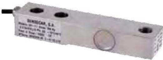
Capacità: 300/500/750/1000/1500 kg • 4000 divisioni OIML-R60 • Supporto elastico di acciaio allegato • Protezione anticorrosione con nichel • Protezione contro l'umidità IP-67 • Materiale acciaio inox
