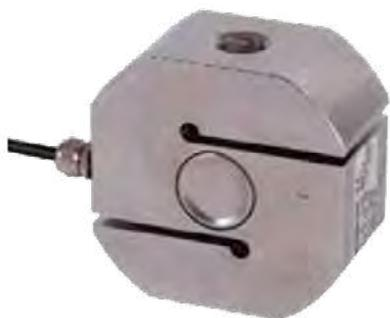
Capacità: 750/1000/1500/2000/2500/3000/6000/10000 kg • Fino a 4000 divisioni OIML-R60 • Supporto elastico di acciaio allegato • Protezione anticorrosione con nichel • Protezione contro l'umidità IP-67 • Materiale acciaio inox
