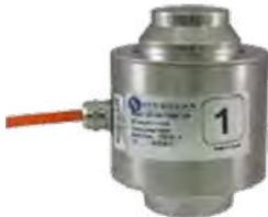
Capacità: 10 - 15 - 20 - 25 - 30 - 35 - 40 - 50 t • Cella di carico a compressione • Fino a 6000 divisioni OIML-R60 • Totalmente in acciaio inox • Totalmente saldata. Protezione interna IP-69K (EN DIN40050-9) • Con scaricatori di gas a protezione contro le scariche atmosferiche • Disponibile cavo metallico antiroditori
