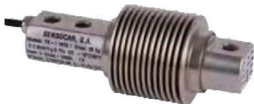
Capacità: 10/15/25/50/100/150/200 kg • 4000 divisioni OIML-R60 • Supporto elastico di acciaio allegato • Protezione anticorrosione con nichel • Sigillato ermeticamente • Protezione contro l'umidità IP-68 • Materiale acciaio inox
