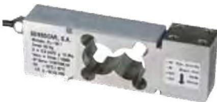
Capacità: 25/50/75/100/150/200/250 kg • Fino a 6000 divisioni OIML-R60 • Supporto elastico di acciaio allegato • Protezione anticorrosione con nichel • Protezione contro l'umidità IP-67 • Alta accuratezza con off-center carica 500x500 • Materiale acciaio inox
