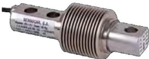
Capacità: 15/25/30/50/75/100/150/200/250/300/500/750/1000/1500 kg • 4000 divisioni OIML-R60 • Supporto elastico di acciaio allegato • Protezione anticorrosione con nichel • Sigillato ermeticamente • Protezione contro l'umidità IP-68 • Materiale acciaio inox
