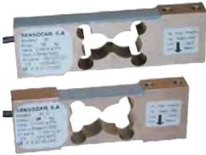
Capacità: 5/7/10/15/18/20/36/40 kg • Fino a 6000 divisioni OIML-R60 • Supporto elastico di acciaio allegato • Trattamento anticorrosione di nichel • Protezione contro l'umidità IP-67 • Alta accuratezza con via-centro carica 380x380 • Materiale acciaio inox
