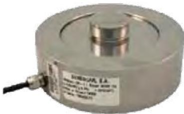
Capacità: 20-30 t • Cella di carico a compressione a basso profilo • Fino a 1000 divisioni OIML-R60 • Totalmente in acciaio inox • Protezione interna IP-68 • Con scaricatori di gas a protezione contro le scariche atmosferiche
